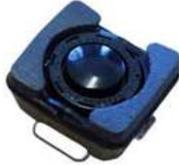
Gambar 6. Mikrofon Piezoelektris
